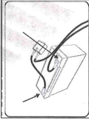
Conectar el cable de la batería: clavija roja con cable rojo, clavija negra con cable negro (evite insertar la batería con la polaridad incorrecta).
